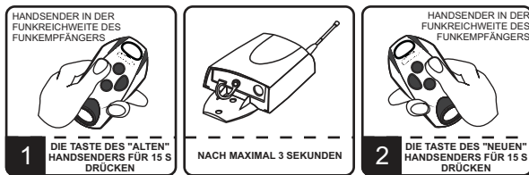
Abb. 7. Ferngesteuertes Hinzufügen der Handsender
